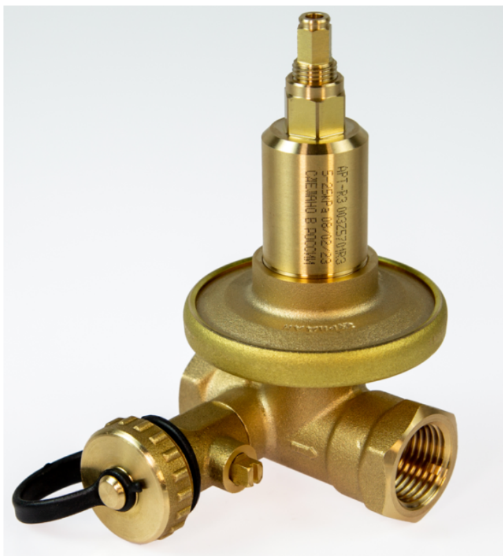
Клапаны АРТ-R3 - регуляторы постоянства перепада давлений, предназначенные для гидравлической балансировки трубопроводных систем тепло- и холодоснабжения при переменных расходах проходящей через них среды в диапазоне от 0 до 100% (Рис.1). Не предназначены для контакта с питьевой водой в системах хозяйственно-питьевого водоснабжения.
